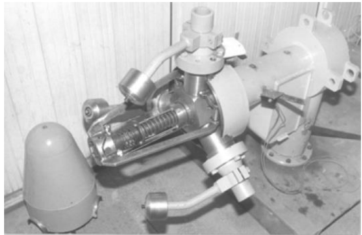
Fig. 8. Mecanism prevăzut cu mase pentru crearea momentului de rotație în plan tangențial și reglarea poziției palelor unei turbine eoliene.
