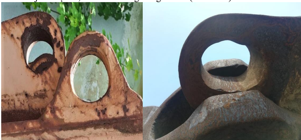
Găuri ovalizate la un încărcător
